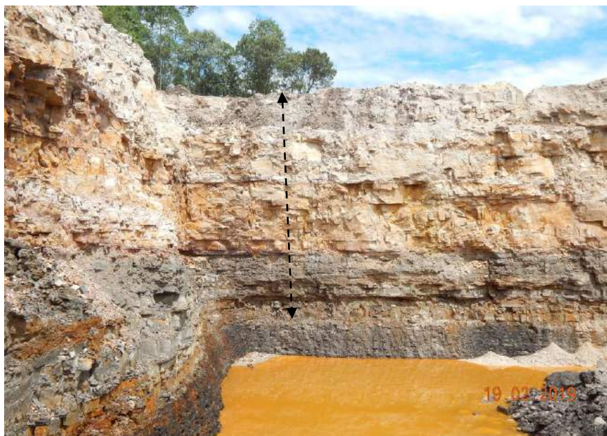
Figura 11: Pacote típico da Formação Rio Bonito, no local atualmente lavrado. Na base se visualiza a camada de carvão “barro branco” sobreposta por uma camada fina de siltito cinza escuro, e a sequência de arenitos, acima. O “pacote” detonado é representado pela espessura arenítica acima da camada de carvão.
