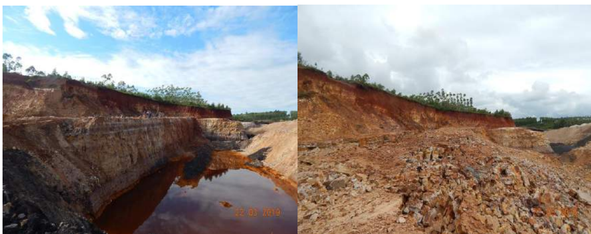
Figura 9: Bancada antes da detonação, a esquerda, e após o desmonte a direita.
